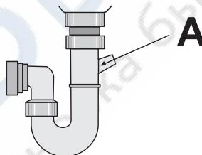
**i** В машине имеется защитное устройство, предотвращающее обратное попадание в нее сточной воды. Если в сливной трубе раковины имеется встроенный обратный клапан, это может помешать нормальному слиянию воды из машины. Снимите обратный клапан.
